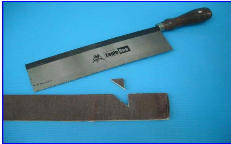
ภาพที่ 15 รูปภาพการใช้เลื่อยรอตตัดปากไม้
