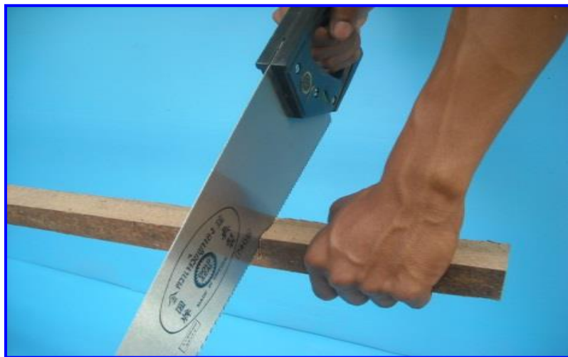
ภาพที่ 8 รูปภาพการใช้เลื่อยลันดาตัดไม้
