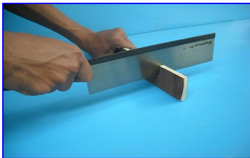
ภาพที่ 14 รูปภาพการใช้เลื่อยรอกตัดปากไม้
