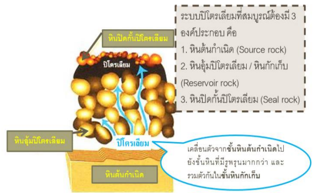
รูปภาพที่ 1.2 องค์ประกอบการกำเนิดปิโตรเลียม (ที่มา : http://www.vcharkam.com/varticle/43165 )
