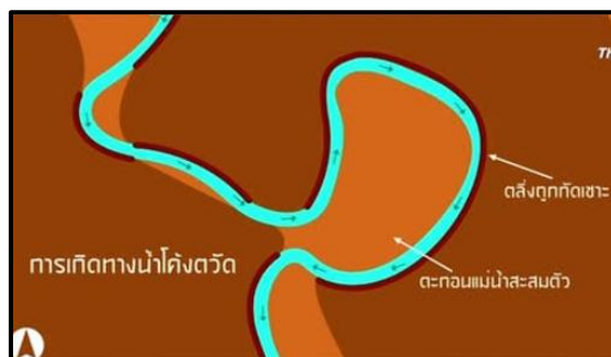
ภาพที่ 11 ลำน้ำตัดตรงบริเวณคอคอด และการเกิดทะเลสาบรูปแอก
