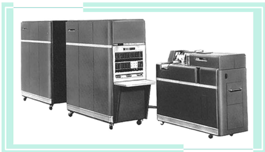
ภาพที่ 2.14 ตัวอย่างเครื่อง IBM 650
