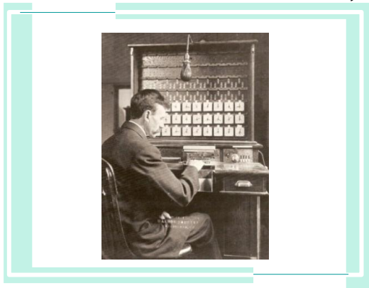
ภาพที่ 2.7 Dr.Herman Hoolerith กับเครื่อง Tabulating Machines ที่สามารถจัดเรียงข้อมูลและคัดเลือกข้อมูลจากบัตรเจาะรูได้โดยอัตโนมัติ
