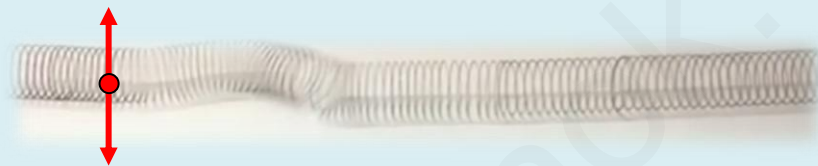
ภาพที่ 1 สั่นสปริงตามแนวขวางของสปริง
