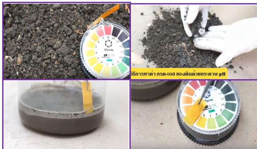
ภาพที่ 5 การวัดความเป็นกรด - เบสของดิน
