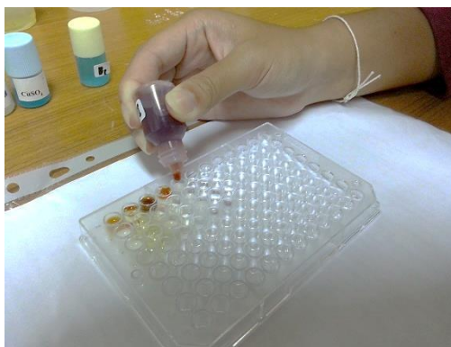
ภาพที่ 2 และ 3 ตัวอย่างการทดลองหยดสารปริมาณน้อยลงในภาตหลุมพลาสติกแทนหลอดทดลอง
