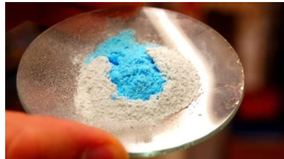
ภาพที่ 7 การทดสอบน้ำโดยใช้จุนสีตะตุ ที่มา : https://goo.gl/18i139 สืบค้นเมื่อวันที่ 4 มกราคม 2557
