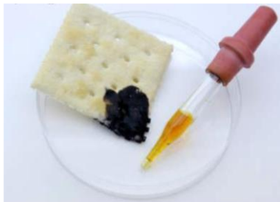
ภาพที่ 3 การทดสอบแป้งในขนมปัง ที่มา : power point อจท.วิทยาศาสตร์ม.2 สืบค้นเมื่อวันที่ 4 มกราคม 2557
