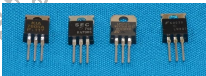
ภาพที่ 2.6 รูปร่างจริงของไอซีสำเร็จรูปในงาน Regulators ด้วยไอซีเร็กกูเลเตอร์ หรือไอซีรักษาแรงดัน ที่มา : ครูธัญญ์พิชชา ท้วมทับ, [2560].
