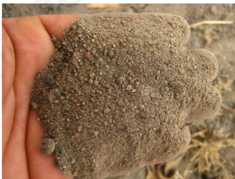
รูปที่ 3 ดินทรายไม่สามารถยึดเป็นเส้นได้
