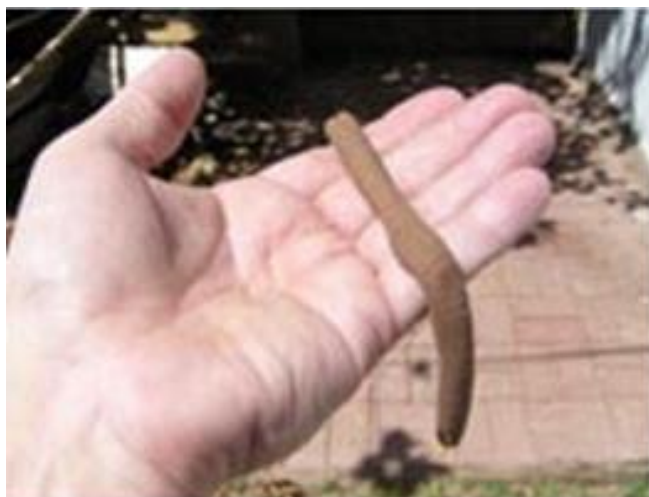
รูปที่ 4 ดินเหนียวสามารถยืดเป็นเส้นได้
