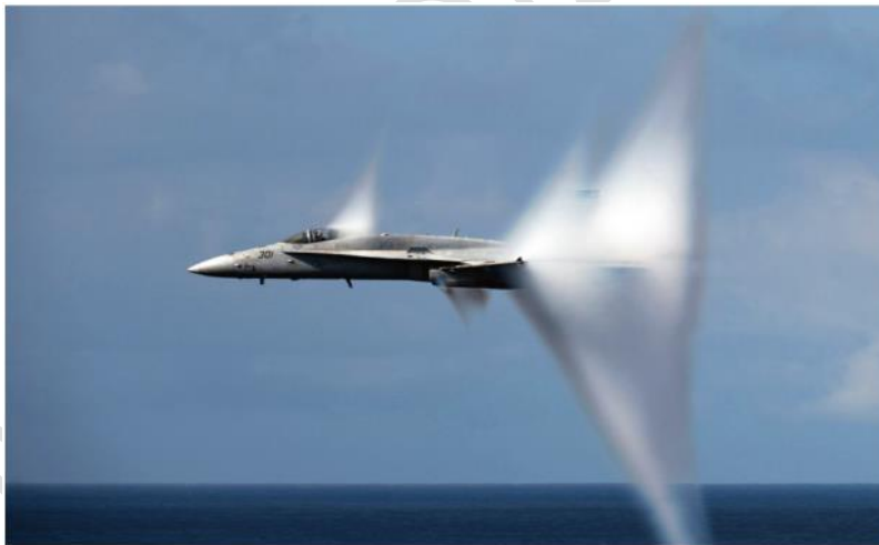
รูปที่ 2 การเกิดคลื่นกระแทกจากเครื่องบินด้วยอัตราเร็วเหนือเสียง
