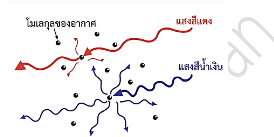
รูปที่ 12 การกระเจิงของแสงเมื่อตกกระทบกับโมเลกุลของแก๊สในบรรยากาศของโลก
