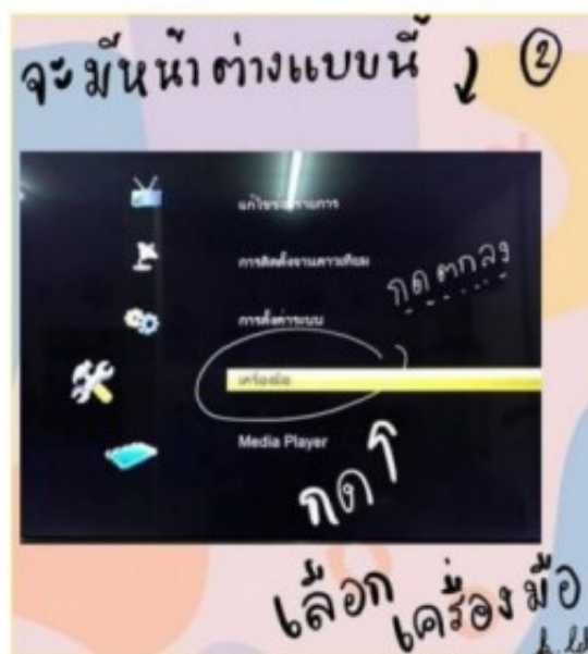
ภาพที่ 12 การเข้าใช้งานเมนูเพื่ออัปเดต OTA
