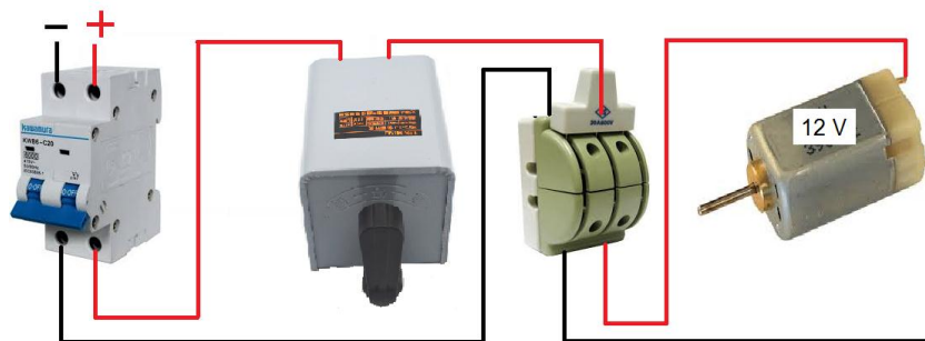
รูปที่ 1.22 เฉลยวงจรกลับทางหมุนมอเตอร์ไฟฟ้ากระแสตรงด้วยสวิตช์ 2 ขั้วสับ 2 ทาง (DPDT. Switch) จากรูปที่ 1.15
