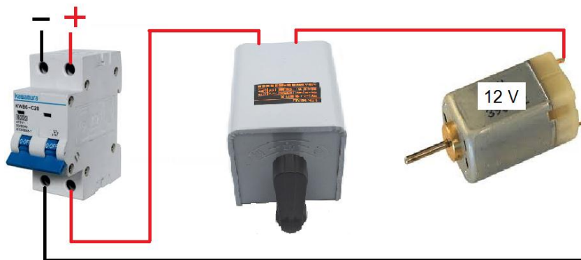
รูปที่ 1.21 เลย์วางวงจรเริ่มเดินมอเตอร์ไฟฟ้ากระแสตรงแบบขนานจากรูปที่ 1.13
