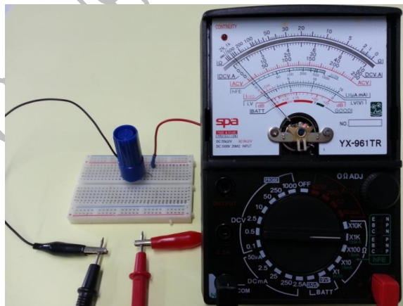
ภาพที่ 1.6 การใช้มัลติมิเตอร์วัด LDR กรณี ไม่ได้รับแสง
