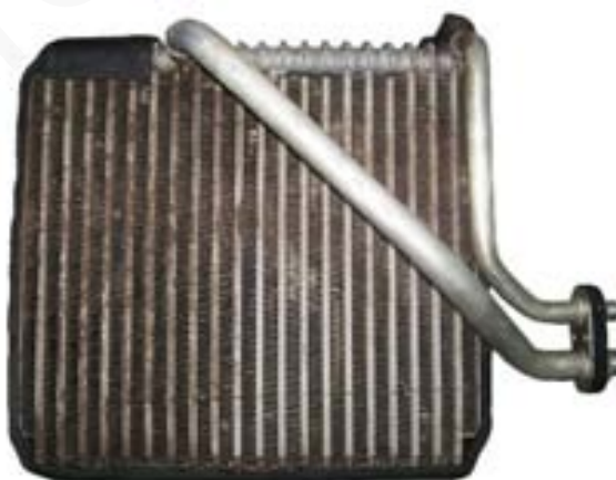
รูปที่ 6.6 อีวาพอเรเตอร์แบบแผ่นเกล็ด
