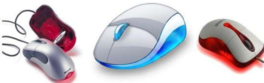
ภาพที่ 13 : เม้าส์แบบแสงหรืออปติคอลเม้าส์
