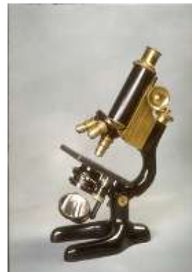
ภาพที่ 1 กล้องจุลทรรศน์ใช้แหล่งกำเนิดแสงจากดวงอาทิตย์ ที่มา http://www.geocities.ws/game_41305/11.htm
