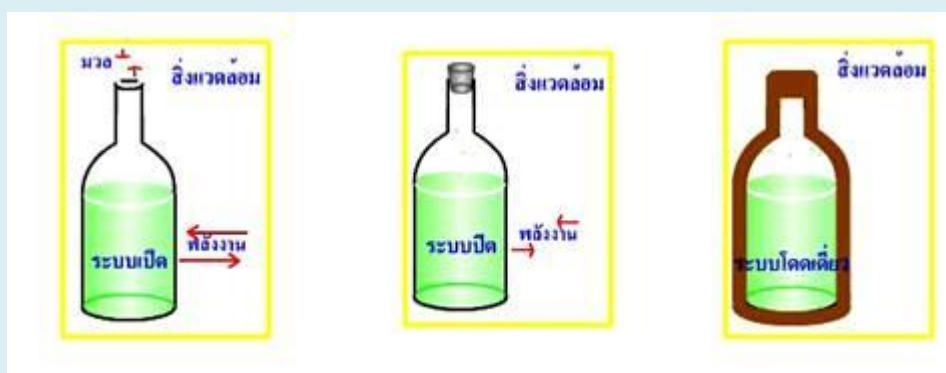
ภาพที่ 8 สรุปสมบัติของระบบปิด ระบบเปิด ระบบโดดเดี่ยว
