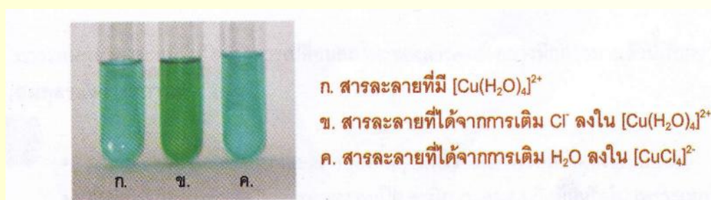
ภาพที่ 20 ผลการทดสอบปฏิกิริยาระหว่างสารละลายคอปเปอร์ (II) ซัลเฟตกับสารละลายกรดไฮโดรคลอริก
